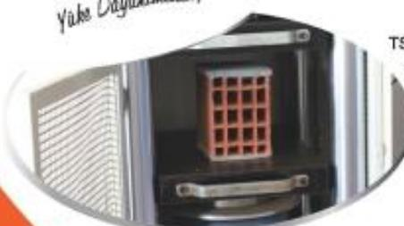
TS EN 772-1 'basınç dayanımı tayınlı' standartına göre test edilen tuğlalarımız yüksek mukavemetler ile dikkat çekmektedir. Bu kalitenin en önemli kriterleri; kaliteli hamadden, iyi kıl işleme, kontrollü pişirmedir.
